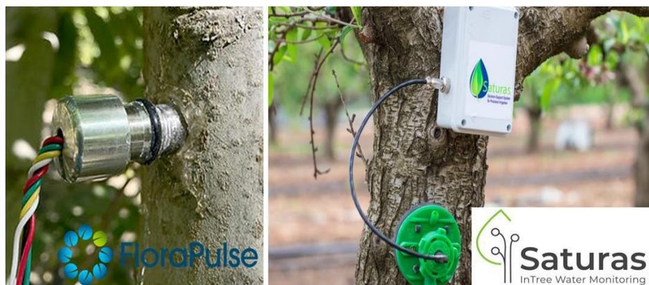
Abbildung 2: FloraPulse- (links) und Saturas-Sensoren (rechts) zur Messung des Wasserpotenzials in Baumstämmen
